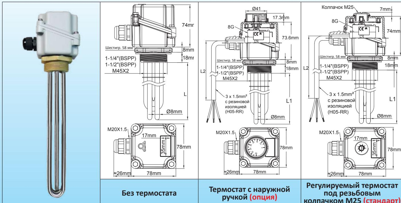
**Основные области применения:** нагрев жидкости, контуры горячего водоснабжения, емкости и буферные резервуары. Эти обогреватели имеют наименьший размер с алюминиевым корпусом, в котором может быть установлен регулируемый термостат. Но внутри не хватает места, чтобы добавить соединительный блок. Поэтому модели с термостатами поставляются подключенными при помощи кабеля с резиновой изоляцией длиной 2 метра, 3 × 1,5 мм<sup>2</sup>.
