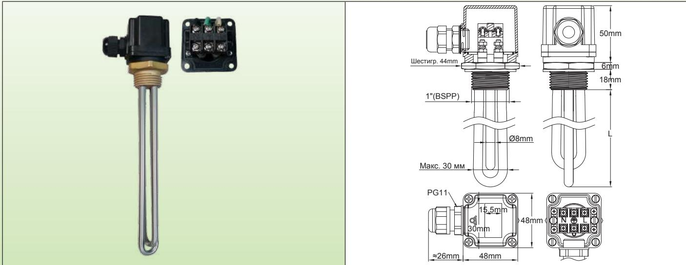
**Основные области применения:** нагрев жидкости, контуры горячего водоснабжения, емкости и буферные резервуары. Имеет 2 нагревательных элемента диам. 8 мм, 230 В, подключены параллельно. Последовательное подключение этих элементов позволяет использовать их при напряжении 115 В.
