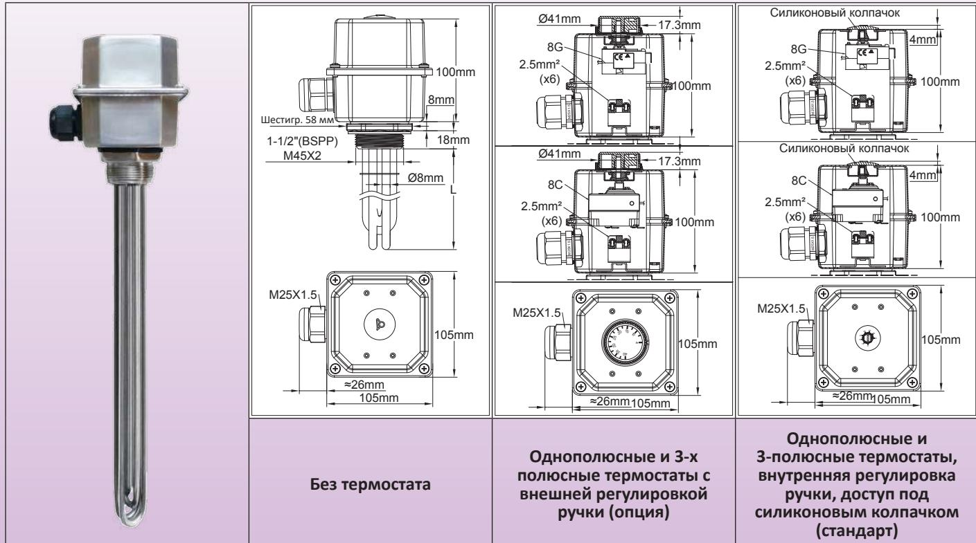
**Основные области применения:** нагрев жидкости, контуры горячего водоснабжения, емкости и буферные резервуары. Эти погружные нагреватели, изготовленные из нержавеющей стали, предназначены для использования в научных, медицинских или коррозионных средах. Все виды сварки выполняются TIG, без применения паяльных сплавов. Они могут быть выполнены из нержавеющей стали марки 304 или 316.
