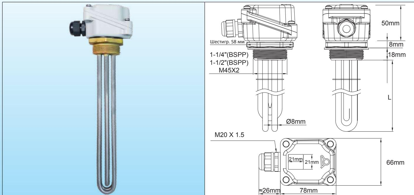
**Основные области применения:** нагрев жидкости, контуры горячего водоснабжения, емкости и буферные резервуары. Эти погружные нагреватели являются самыми маленькими с 3 нагревательными элементами и алюминиевым корпусом. Внутри не хватает места для термостата.
