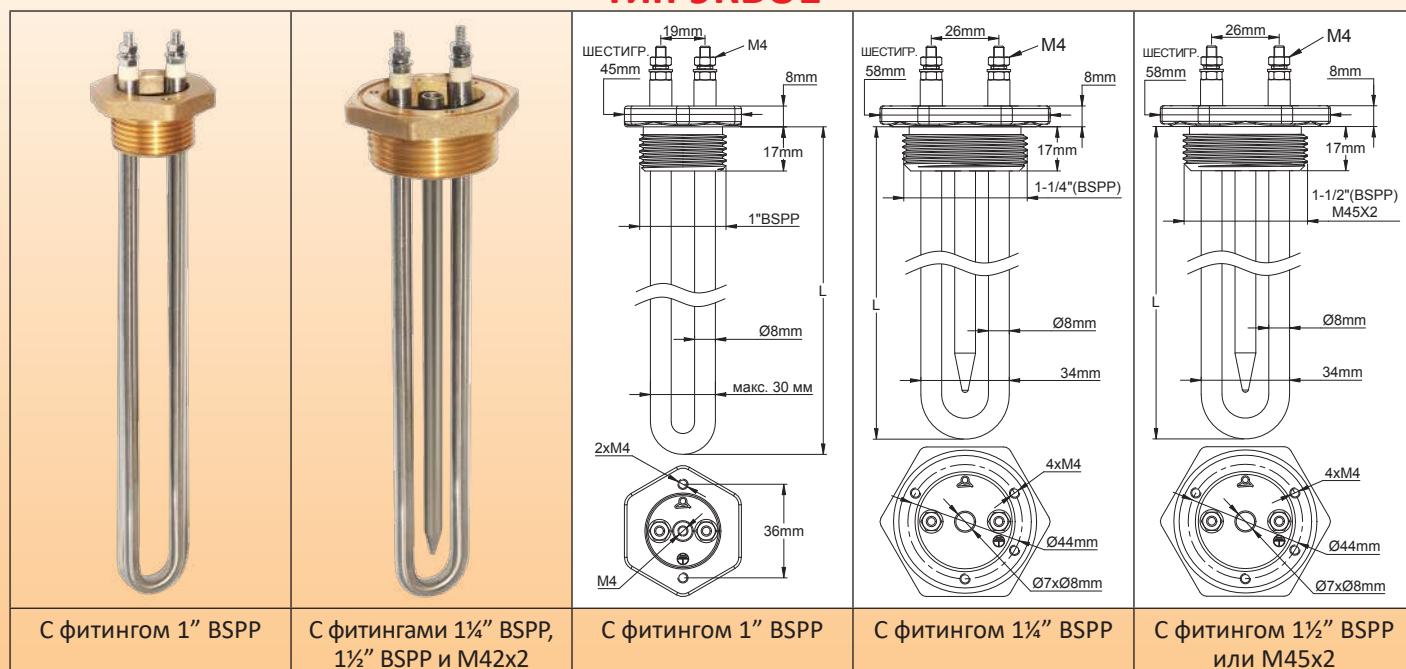
**Основные области применения:** нагрев жидкостей, контуры горячего водоснабжения, контейнеры и буферные емкости. Стандартно они выпускаются в двух вариантах плотности поверхностной нагрузки: 5 Вт/см<sup>2</sup> и 10 Вт/см<sup>2</sup> (другие варианты поставляются по запросу). Для выбора оптимальной нагрузки на поверхность смотрите техническое введение. Многие корпуса для этих нагревателей доступны в нашем каталоге №11.
